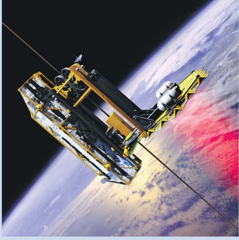
Die Aufzugsabstiege klettert an dem Band über ein System aus Walzen emporklettert, deren Motor durch eine externe Quelle mit Energie versorgt wird. In dieser Illustration ist das ein Hochleistungslaser auf der Erdoberfläche, was aber auch Nucleare hat. In letzter Zeit denken die Ingenieure eher über einen Solartrieb nach (siehe auch links „Aktuelle Pläne“).
